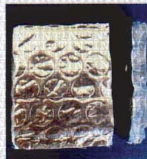
Densidad aparente de la muestra: 59,9 kg/m<sup>3</sup>
